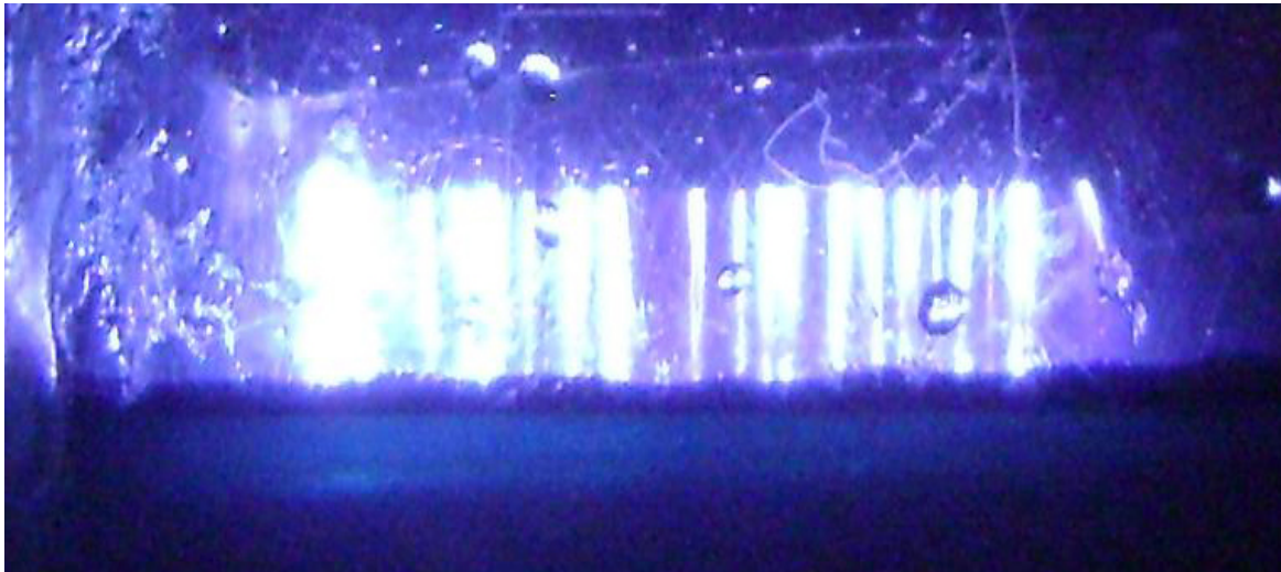
Рис.1. Свічення імпульсного розряду наносекундної тривалості над поверхнею 10% водного розчину мідного купоросу при міжелектродній віддалі 7 мм та товщині шару рідини 4 мм.
