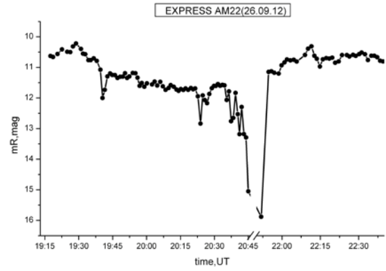
Рис 9. Крива блиску ГСС «Express-AM22» в R фільтрі
