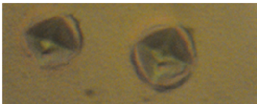
Рис. 3. Часові залежності мікротвердості плівки \text{Ge}_{32}\text{As}_8\text{Se}_{60} під час опромінення лазером та після його виключення. Стрілками показані моменти включення та виключення лазера. Крупними точками показані усереднені (по 5 точках) числові значення H . Фото відбитків у темноті та в кінці опромінення лазером.
