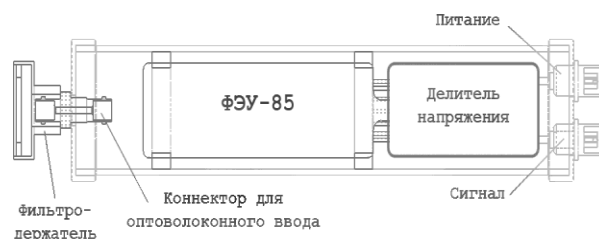
Рис. 1. Датчик оптического излучения на базе ФЭУ. Диапазон чувствительности 240–600 нм.
