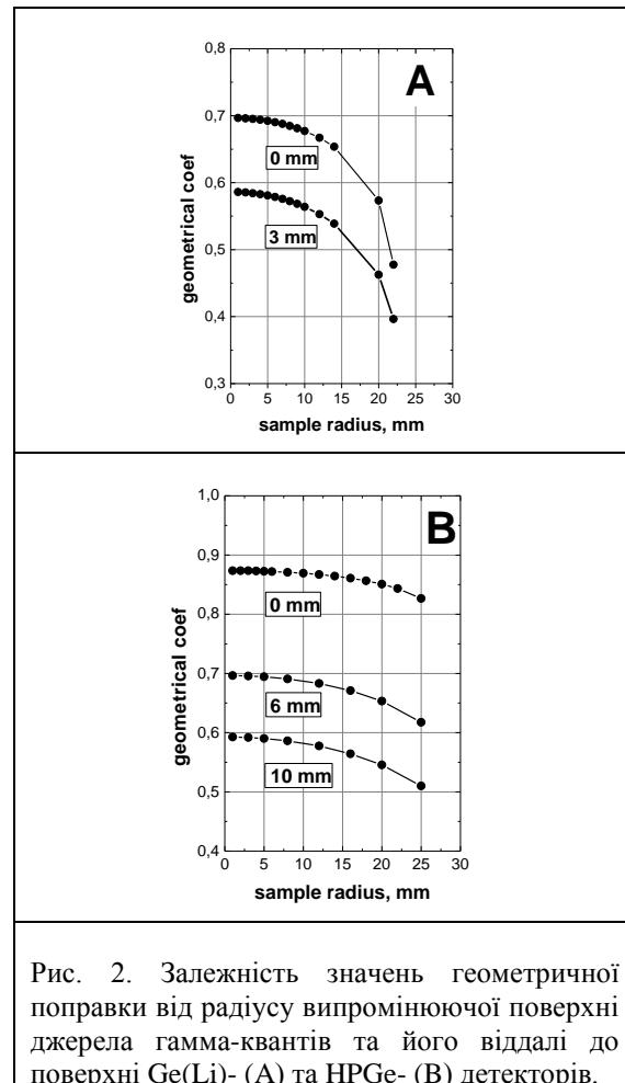
Рис. 2. Залежність значень геометричної поправки від радіусу випромінюючої поверхні джерела гамма-квантів та його віддалі до поверхні Ge(Li)- (A) та HPGe- (B) детекторів.
