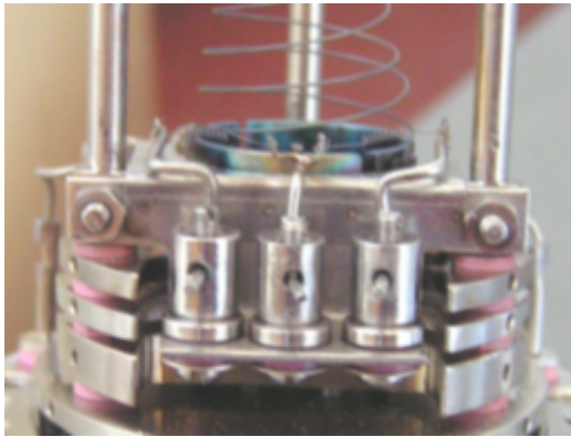
Рис. 8. Вигляд іонізатора джерела іонів датчика мас-спектрометра MX7304AM (циліндричну частину відбивача знято) з установленим блоком катодів.
