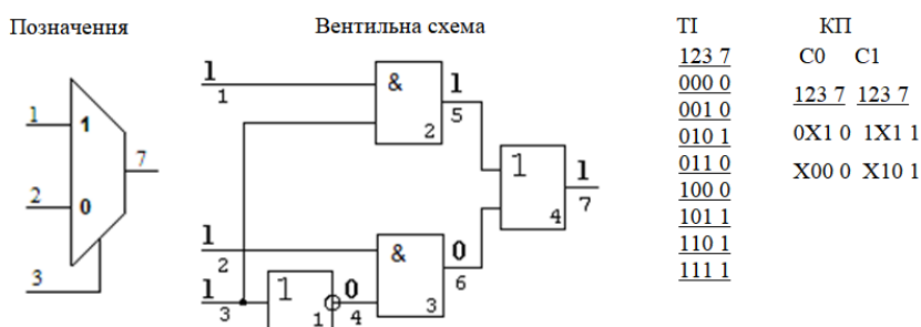
Рис. 5. Структурно-функціональна модель мультиплексора MUX 2-в-1
