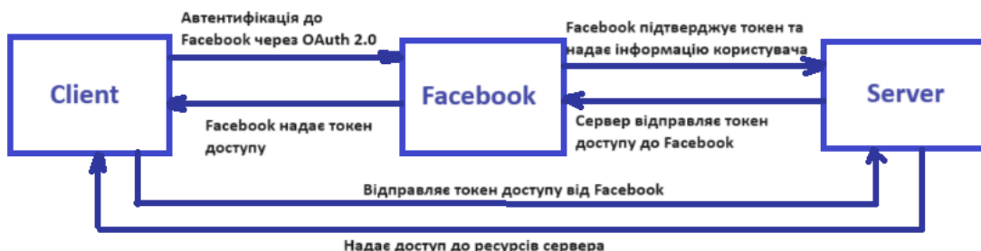
Рис. 1. Схема OAuth 2.0 у реалізації застосунку
