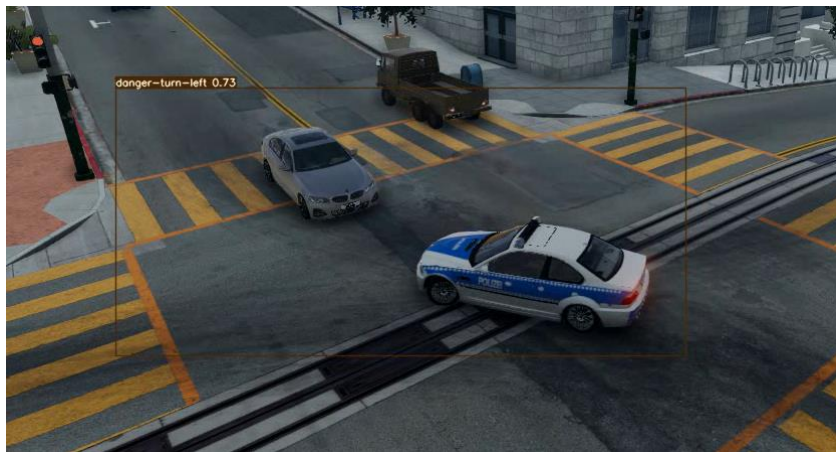
Рис. 6. Результат розпізнавання моделлю YOLOv7 повороту ліворуч як небезпечної ситуації
