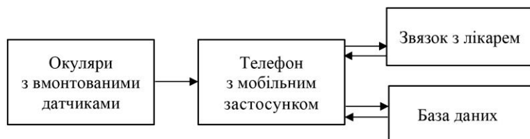
Рис. 1. Схема функціональних модулів системи моніторингу стану здоров'я очей
