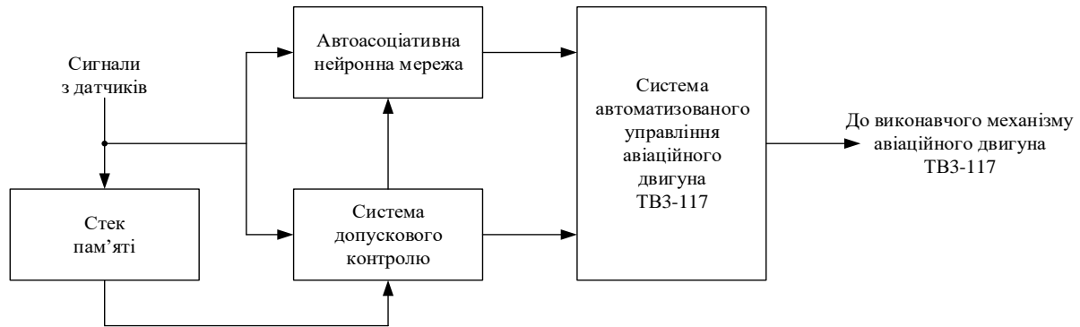
Рис. 2. Функціональна схема відновлення інформації на основі АНМ [10]
