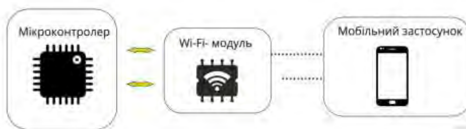
Рис. 4. Схема з'єднання мікроконтролера й мобільного застосунку
