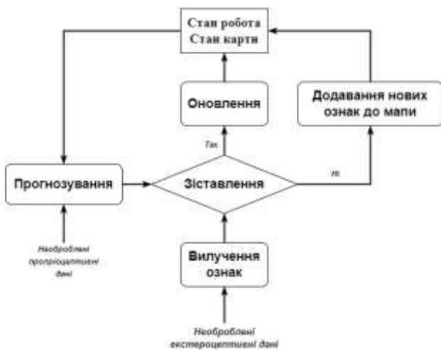
Рис. 1. Блок-діаграма процесу EKF-SLAM
