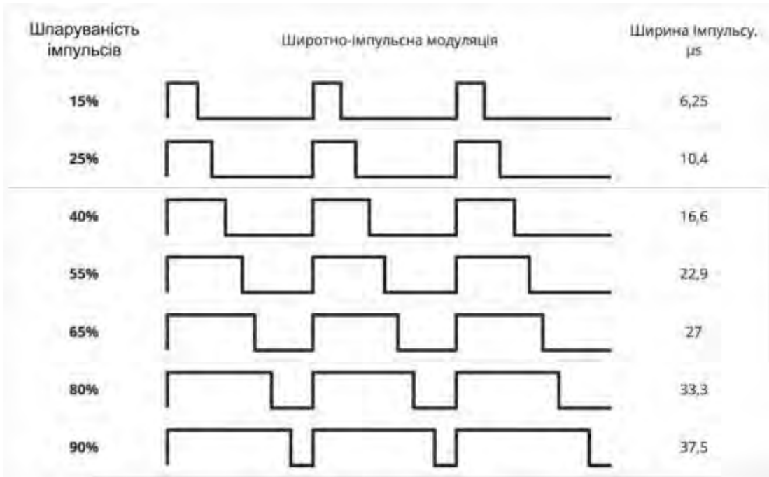
Рис. 9. Таблиця ШІМ в умовах різної шпаруватості
