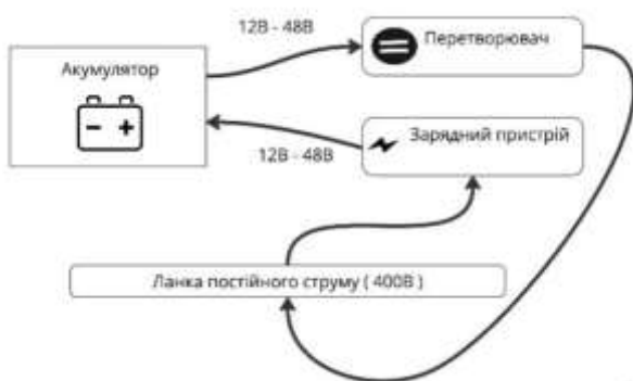
Рис. 2. Схема з'єднання акумулятора й ланки постійного струму
