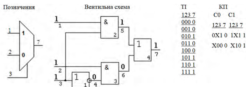
Рис. 5. Структурно-функціональна модель мультиплексора MUX 2-в-1
