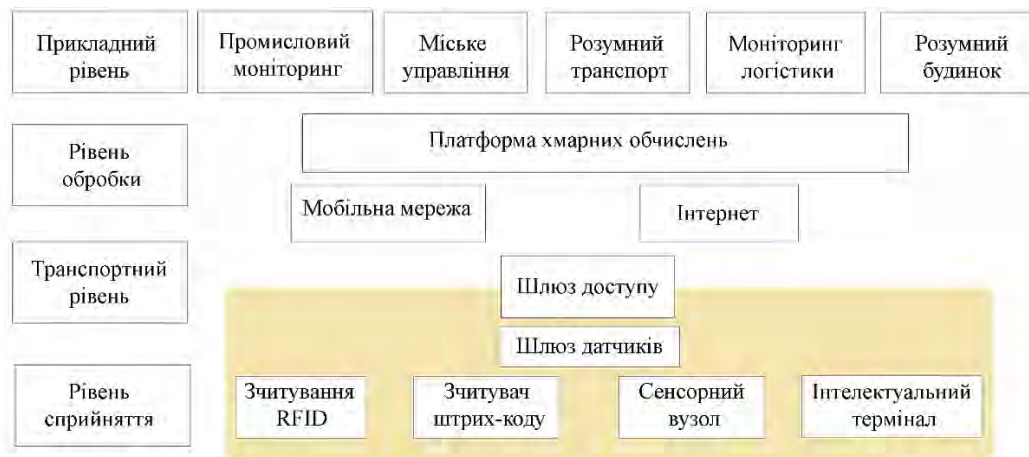
Рис. 3. Відносне положення туманного обчислювального шару в системі Інтернету речей
