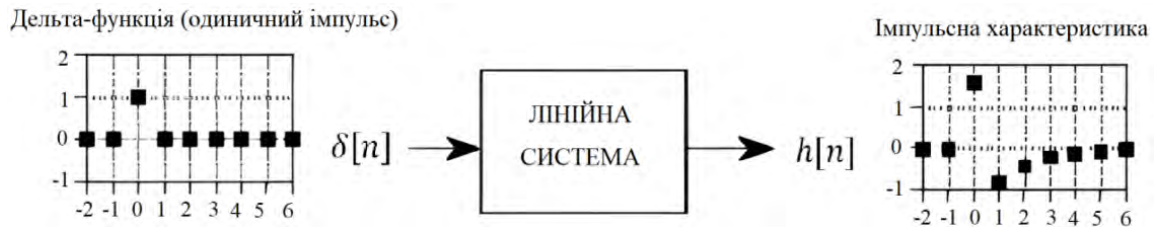
Рис. 1. Візуалізація згортки з дельта-функцією
