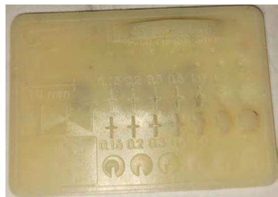
Рис. 11. Надрукована тестова модель
