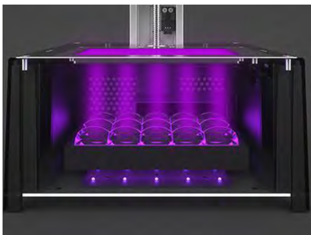
Рис. 4. Світлодіодна матриця з лінзами Френеля
