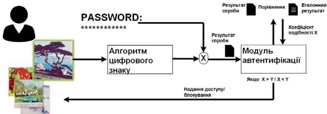
Рис. 1. Спрощена схема автентифікації користувача зображення за допомогою нульового водяного знака
