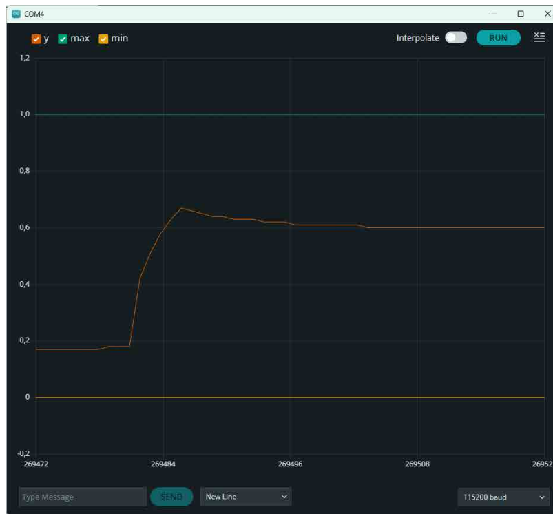
Рис. 13. Графік y(t) ПІД-регулятора для першої спроби налаштування
