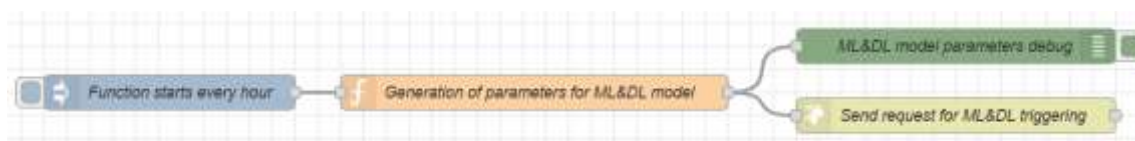
Рис. 5. Потік Node-RED налаштування та передачі гіперпараметрів моделі прогнозування до компонента ML&amp;DL
