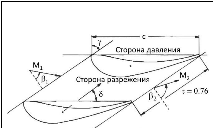
Рис. 1. Решетка турбинных лопаток 4-й стандартной конфигурации:
