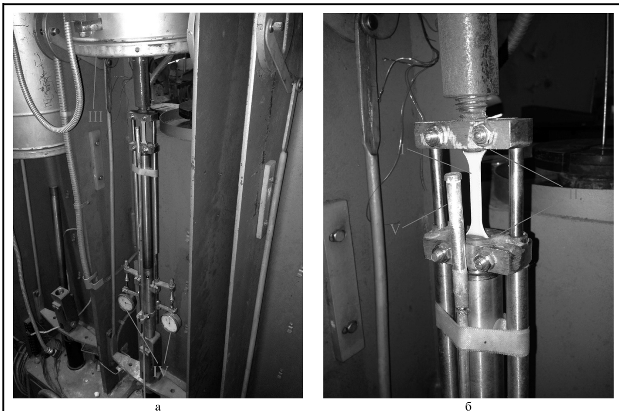
Рис. 8. Экспериментальная машина: а – общий вид; б – вид захватов
