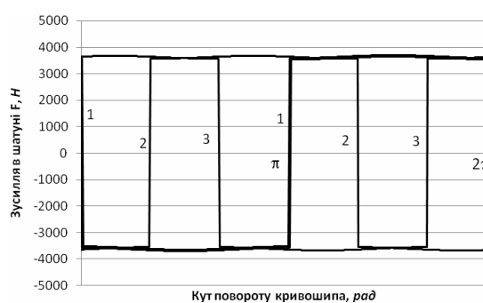
Рис. 5. Графік зміни зусилля в шатунах F_1 (1), F_2 (2), F_3 (3) в залежності від кута повороту кривошипів
