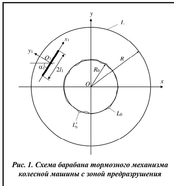
Рис. 1. Схема барабана тормозного механизма колесной машины с зоной предразрушения
