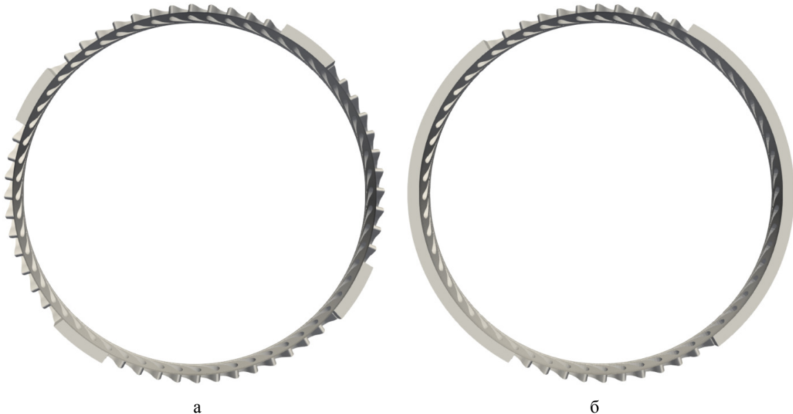
Рис. 3. Конфігурація каналів першого віня: а – режим 100%; б – режими 70 та 50%
