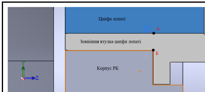
Рис. 12. Розташування характерних точок А і Б для визначення НДС зовнішньої втулки цапфи лопаті
