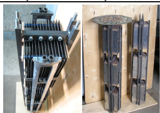
Рис. 1. Конструкція електролізної комірки
