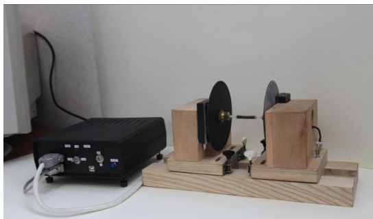
Рис. 4. Стенд двомасової електромеханічної системи стеження
