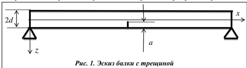
Рис. 1. Эскиз балки с трещиной
