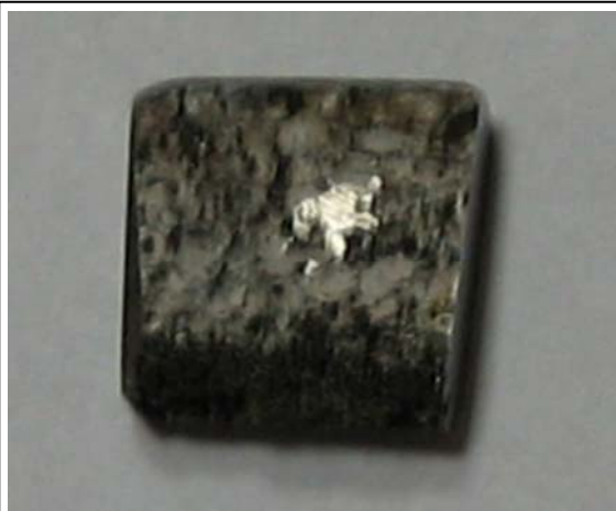
Рис. 4. Экспериментальный образец из материала 20Х13 с противоэрозионным покрытием, нанесенным методом электроискрового упрочнения
