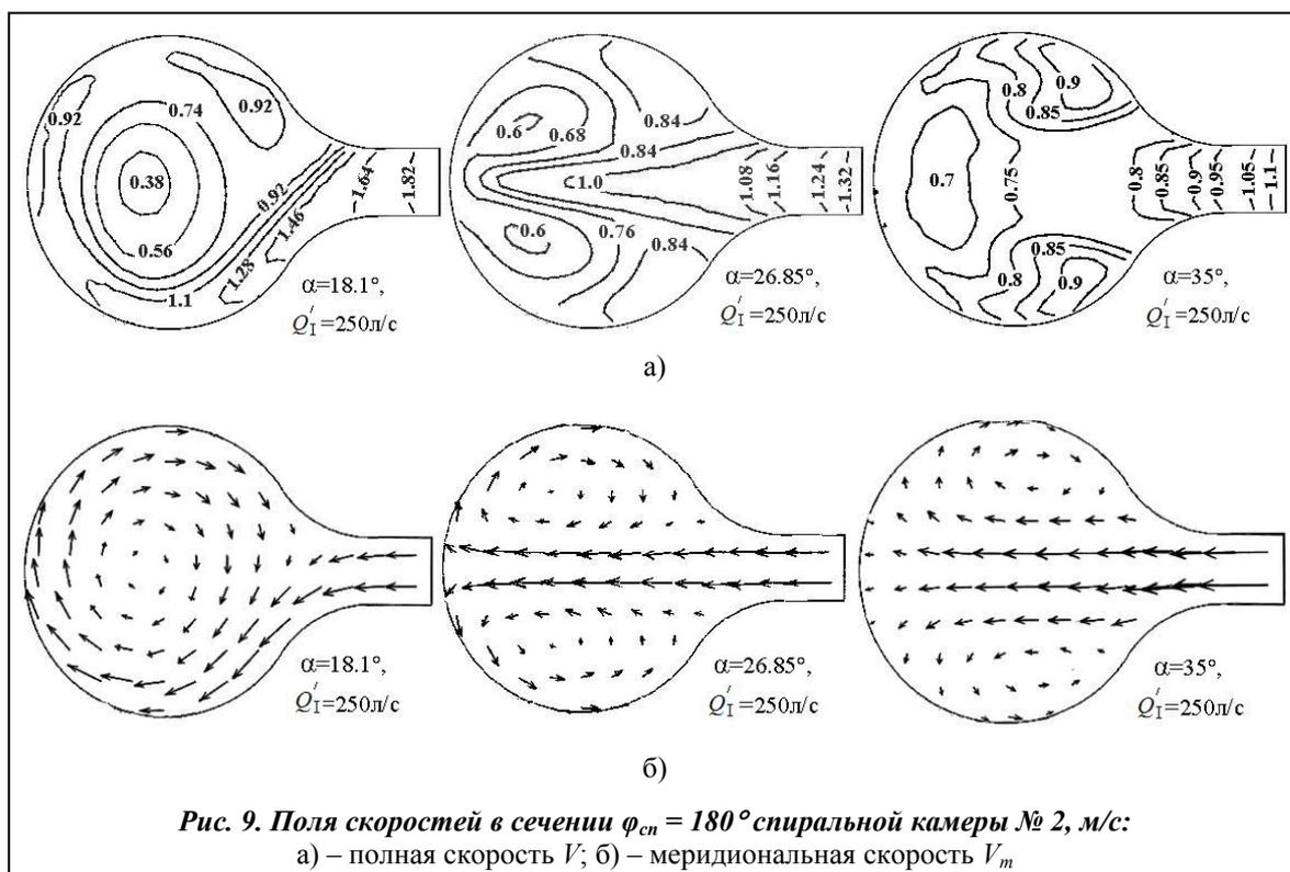
Рис. 9. Поля скоростей в сечении  $\varphi_{en} = 180^\circ$  спиральной камеры № 2, м/с:
