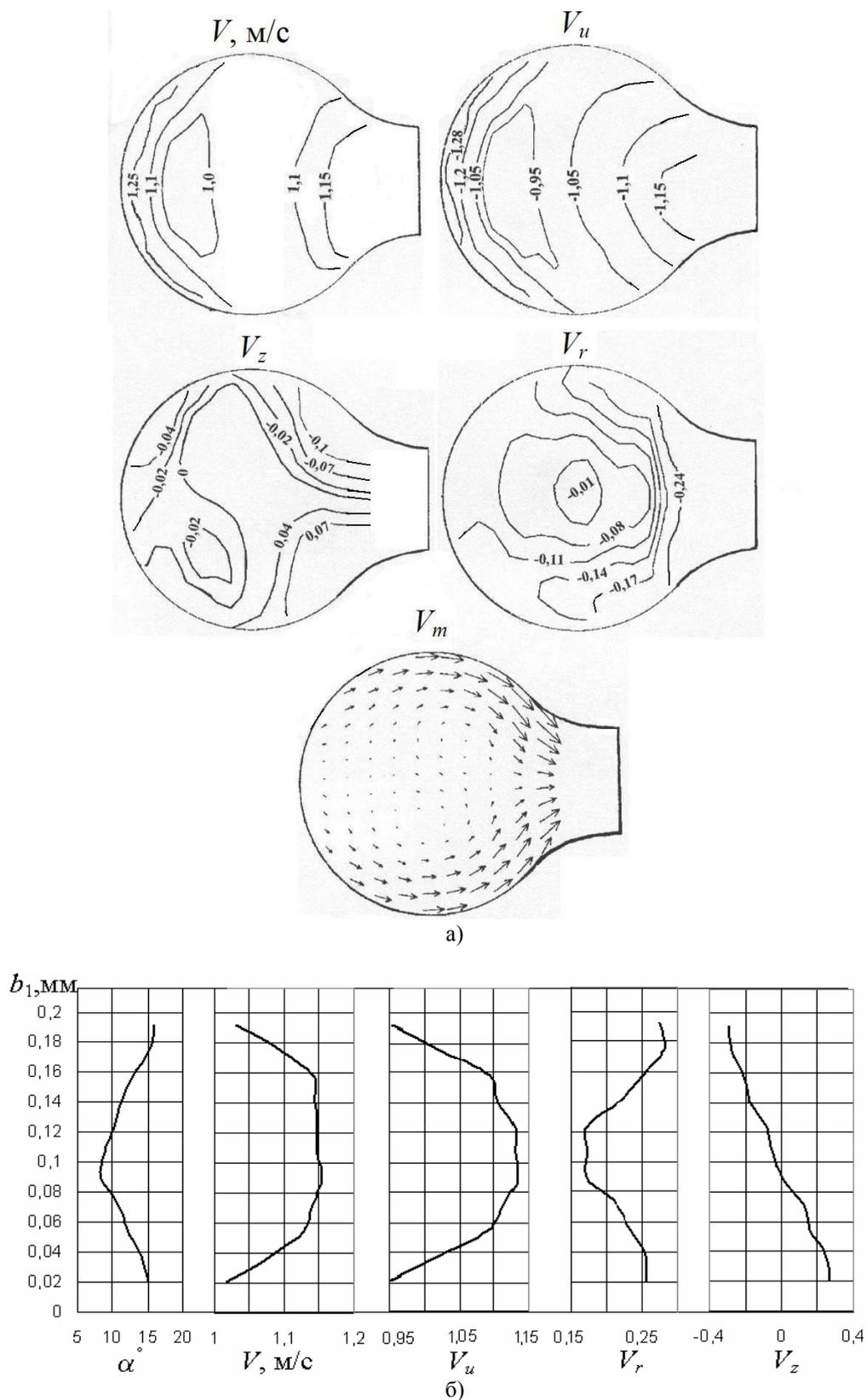
Рис. 2. Структура потока в спиральной камере № 1:
