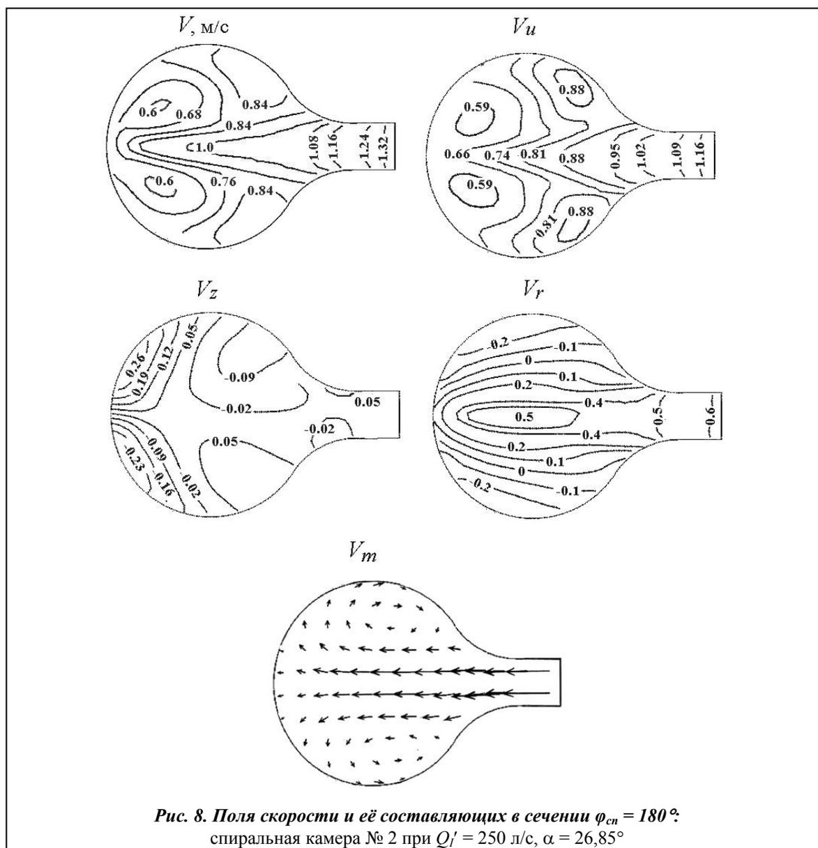
**Рис. 8. Поля скорости и её составляющих в сечении  $\varphi_{сп} = 180^\circ$ : спиральная камера № 2 при  $Q_j' = 250$  л/с,  $\alpha = 26,85^\circ$**
