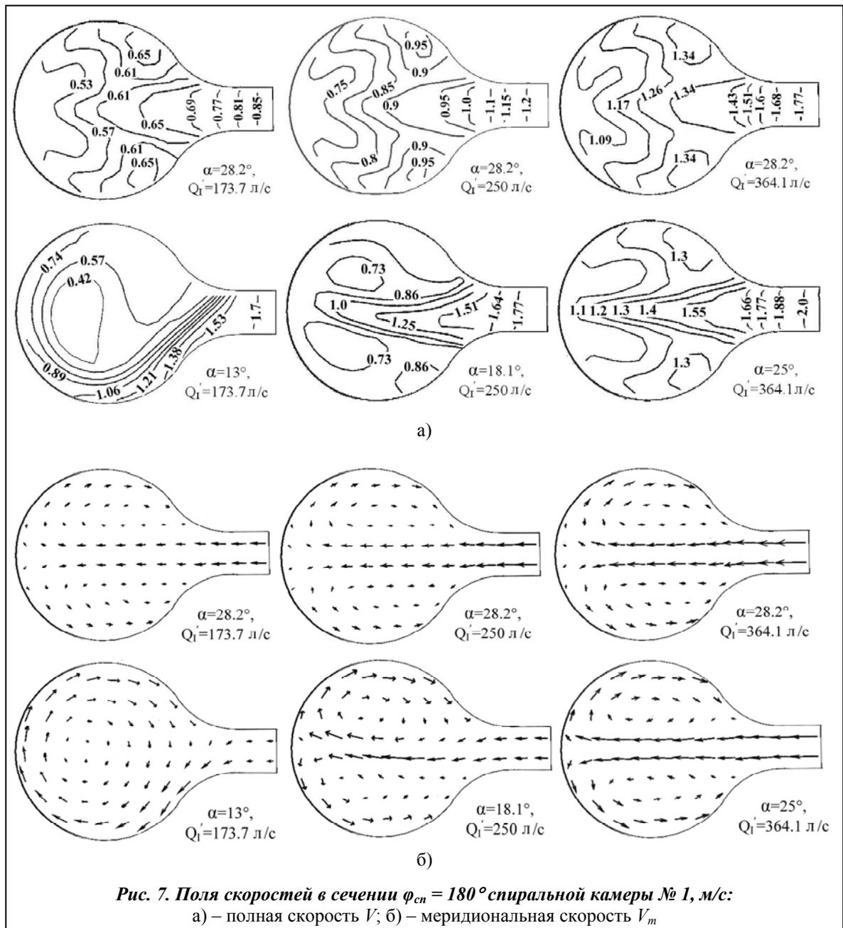
Рис. 7. Поля скоростей в сечении  $\varphi_{cn} = 180^\circ$  спиральной камеры № 1, м/с:
