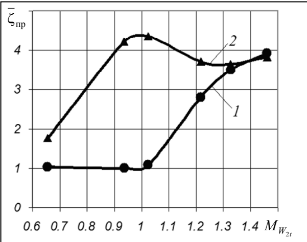
Рис. 3. Зависимость относительного коэффициента профильных потерь от M_{w_{2t}}
