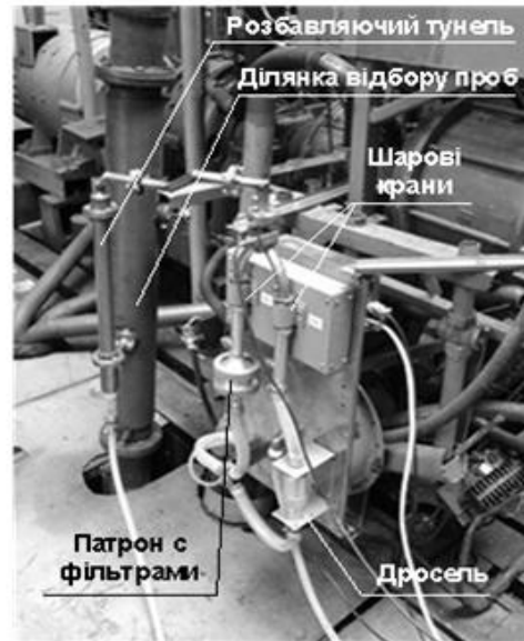
Рис. 4 – Принципова схема та загальний вигляд мікротунелю МКТ-2
