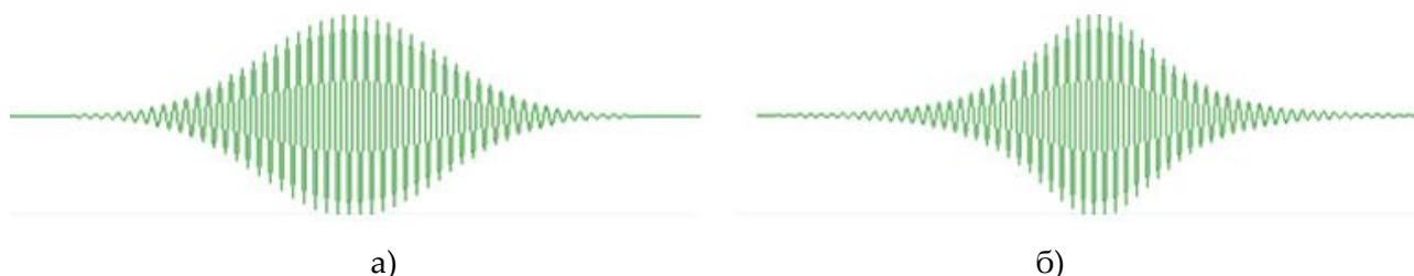
Рис. 2. Радиоимпульсы с различной формой огибающей: а) огибающая в форме гауссова («колокольного») импульса, б) огибающая в форме гиперболического секанса
