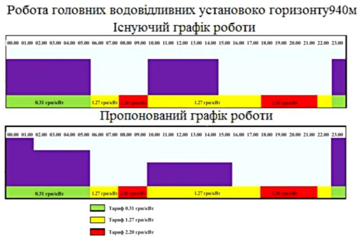
Рис. 6. Робота головних водовідливних установок горизонту 940 м ш. Тернівська
