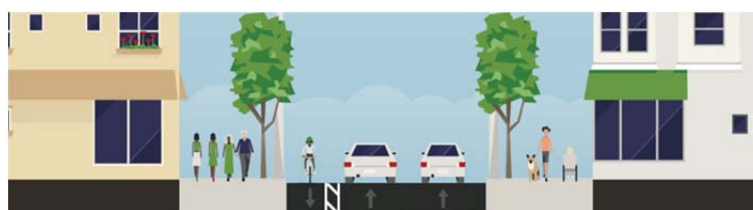
Рис. 5. Влаштування велосипедних смуг в межах проїзної частини вулиць з одностороннім рухом Благовіщенської й Коцарської
