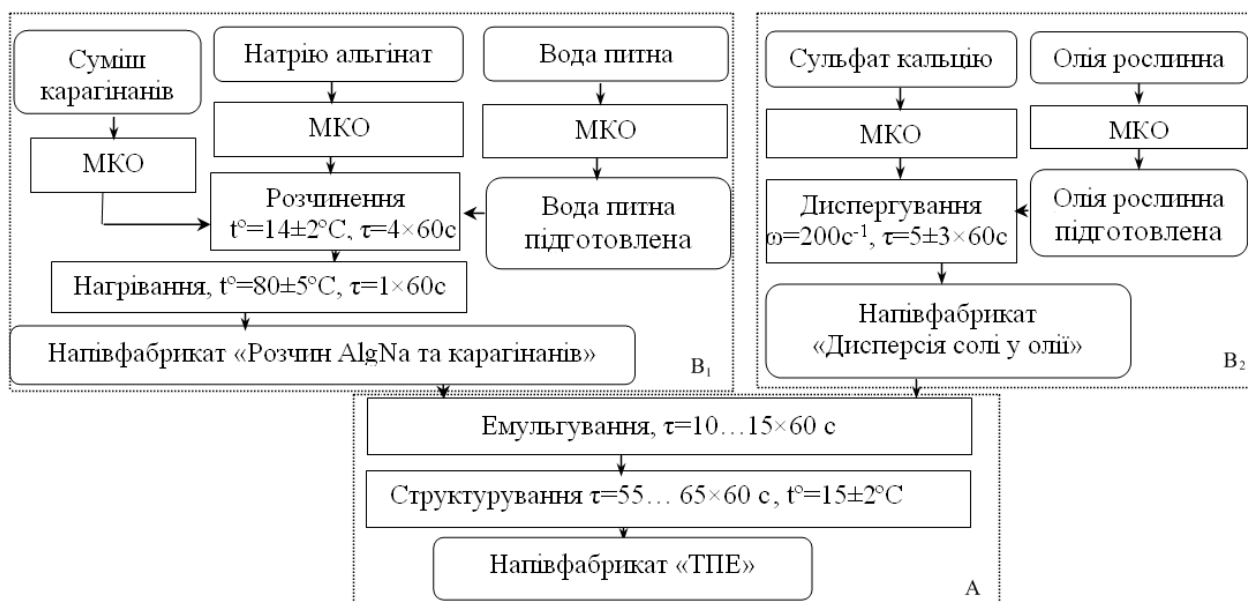
Рис. 3. Технологічна схема отримання м'ясних фаршів з структурованими властивостями
