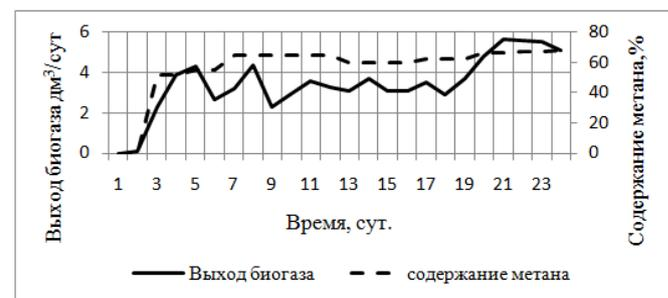
Рис. 2. Процесс образования биогаза и содержание метана в UASB-реакторе
