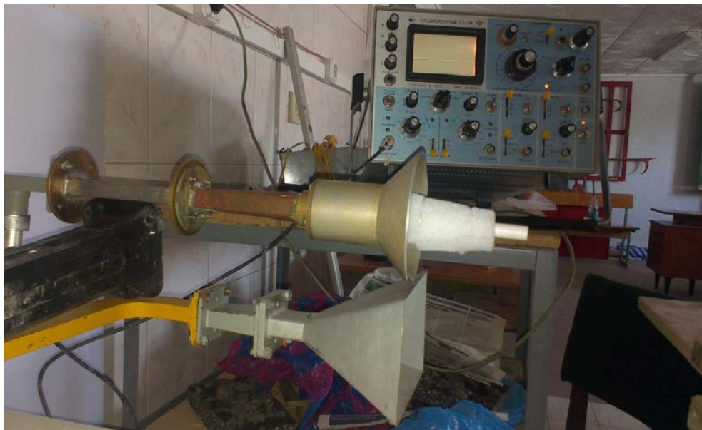
Рис. 3. Макет цилиндрической рупорной антенны с двойным изломом образующей и передающая антенна
