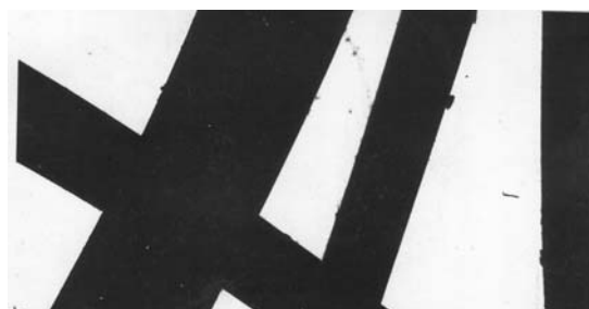
Рис. 3. Нитевидные кристаллы на основе диоксида титана с прайдеритподобной структурой (увеличение 400)
