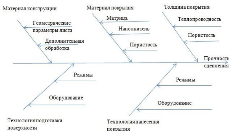
Рис. 3. Причинно-следственная диаграмма Каору-Исикавы для случая формирования защитного слоя методом электродугового
