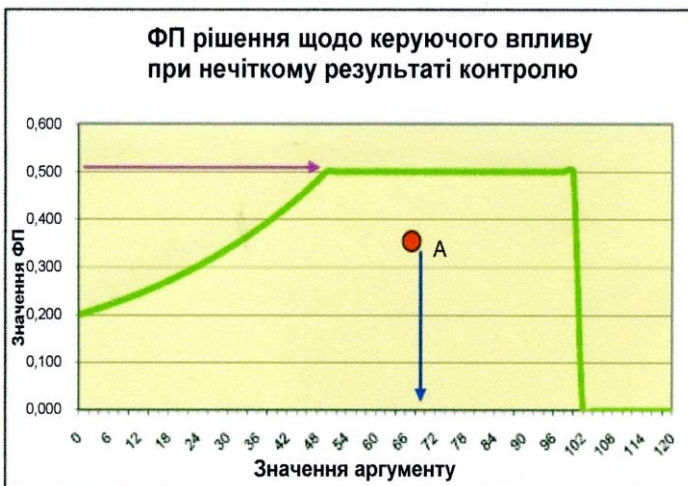
Рис. 8. Вигляд підсумкової ФП для прийняття рішення системи управління технічного стану конструкції при нечіткому контролі
