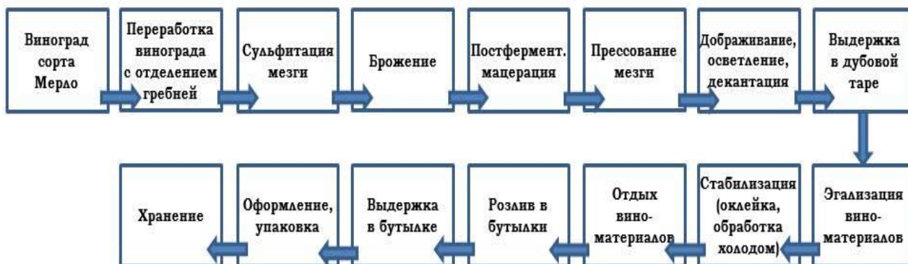
Рис. 1. Технологическая блок-схема производства вин категории КНП
