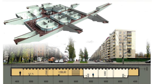
Рис. 6. Підземний пішохідний перехід з торговельними приміщеннями
