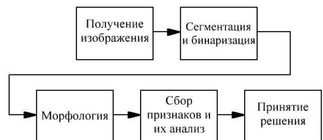
Рис. 2. Упрощенная схема распознавания образов на изображении
