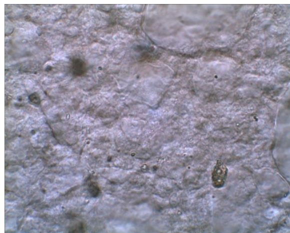
Рис. 2. Дисперсність гелю, що приготований при температурі 20 °С і 1000 об/хв., збільшення ×400
