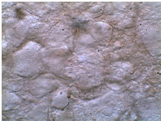
Рис. 1. Дисперсність гелю, що приготований при температурі 20 °С і 500 об/хв., збільшення ×400
