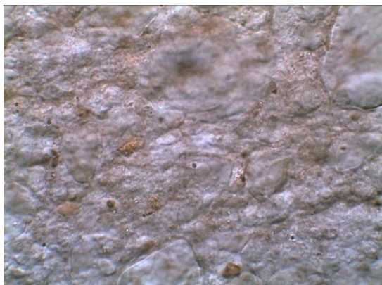
Рис. 4. Дисперсність гелю, що приготований при температурі 20 °С і 2000 об/хв., збільшення \times 400
