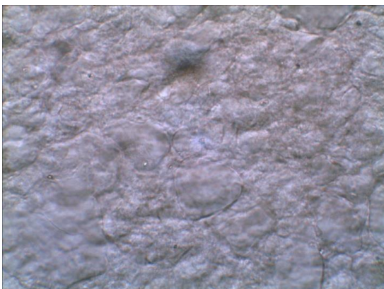
Рис. 6. Дисперсність гелю, що приготований при температурі 40 °С і 1500 об/хв., збільшення \times 400
