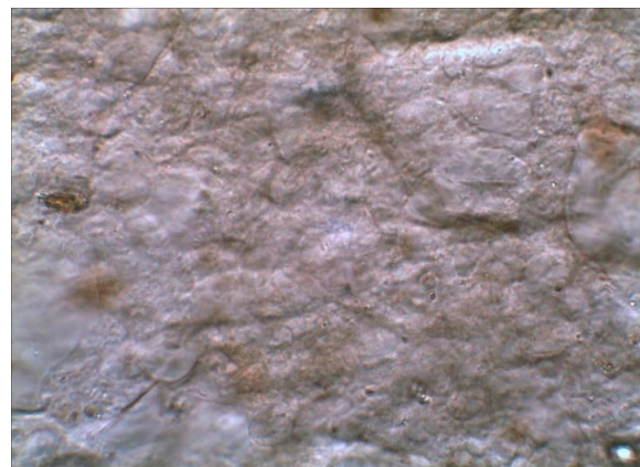
Рис. 3. Дисперсність гелю, що приготований при температурі 20 °С і 1500 об/хв., збільшення ×400
