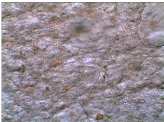
Рис. 5. Дисперсність гелю, що приготований при температурі 20 °С і 1500 об/хв., збільшення \times 400
