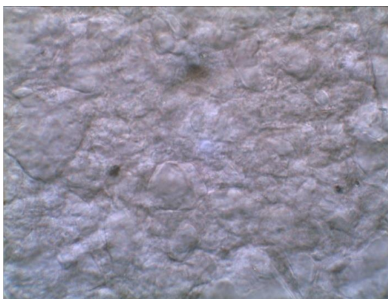
Рис. 8. Дисперсність гелю, що приготований при температурі 80 °С і 1500 об/хв., збільшення \times 400
