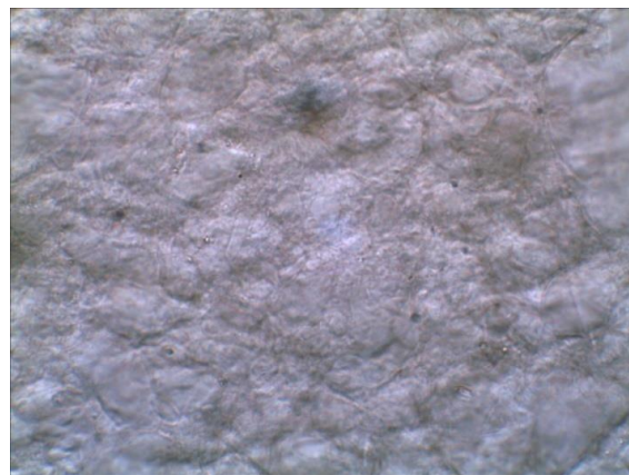
Рис. 7. Дисперсність гелю, що приготований при температурі 60 °С і 1500 об/хв., збільшення \times 400
