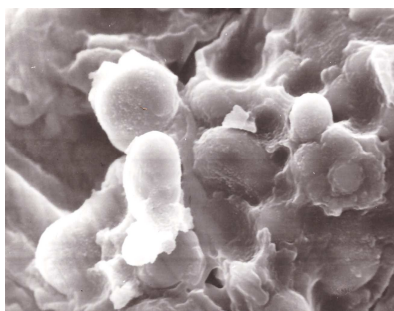
Рис. 5 – Структура центральної частини семян нута после ВТО при P=0,2 МПа, \tau=10 мин., W=9,8 %
