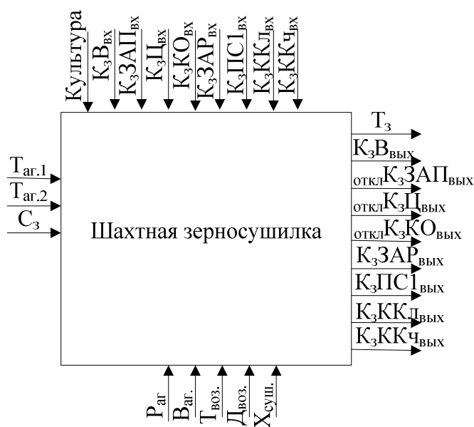
Рис. 1 – Параметрическая схема процесса сушки зерна пшеницы
