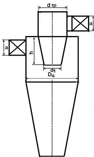
Рис. 1 – Основные конструктивные параметры циклона необходимые для расчета
