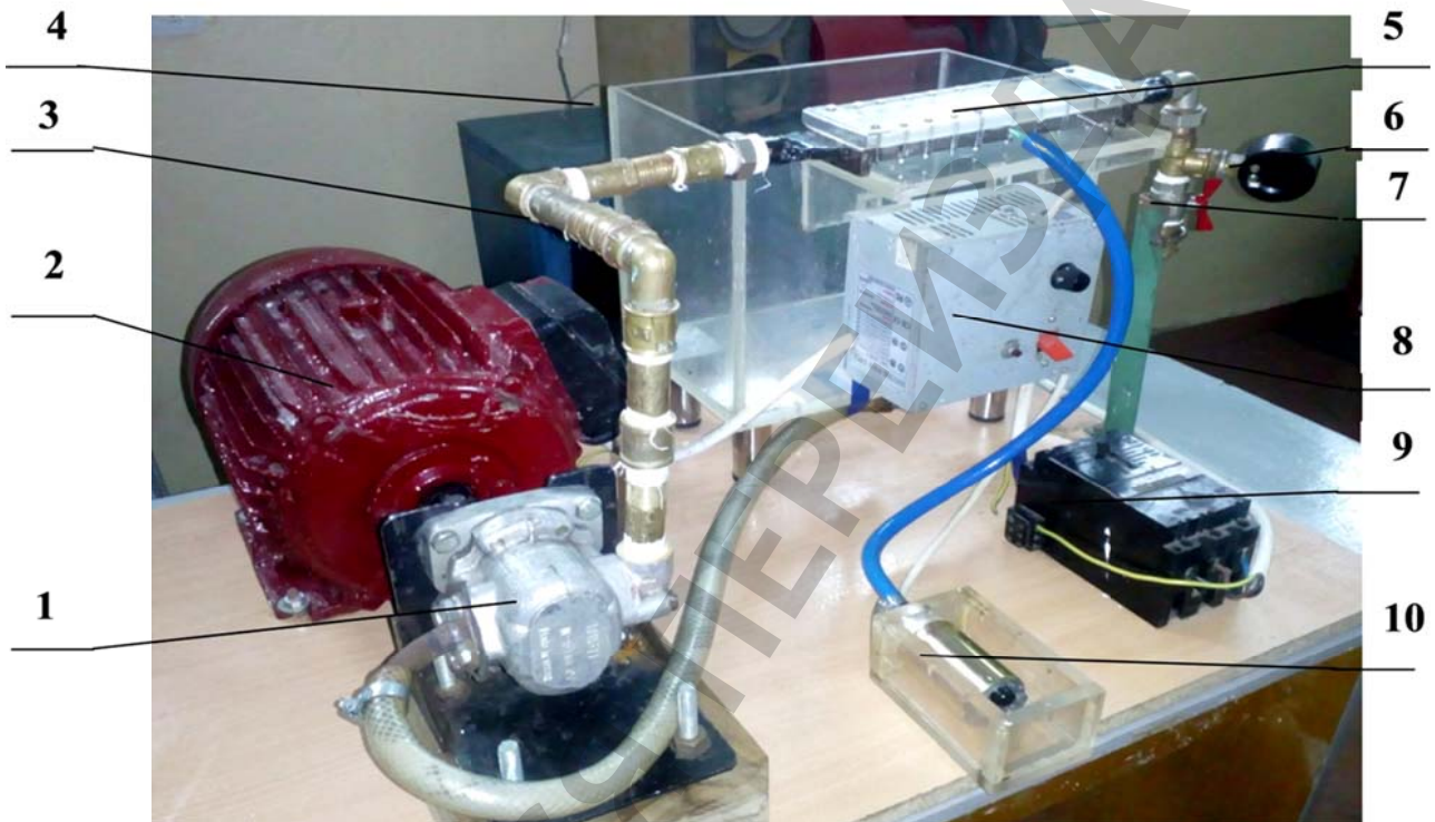
Рис. 1. Схема установки струминного гомогенізатора молока з роздільною подачею вершків: 1 – насос типу НШ 10 (Україна) для подачі знежиреного молока; 2 – електричний двигун трифазний; 3 – з'єднувальні патрубках; 4 – ємність для знежиреного молока; 5 – камера гомогенізації; 6 – манометр; 7 – дроселюючий вентиль; 8 – блок керування насосом подачі вершків; 9 – пакетний вимикач; 10 – ємність з вершками з відцентровим насосом
