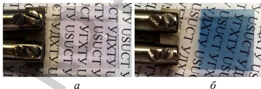
**Рис. 4.** Фотографии осаждённой пленки на FTO-стекле: *а* – из свежеприготовленного электролита; *б* – из электролита, который стоял 1 неделю на свету
