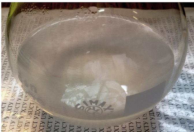
**Рис. 5.** Колба с электролитом для электрохимического нанесения  $WO_3$  (время от приготовления – 1 месяц)
