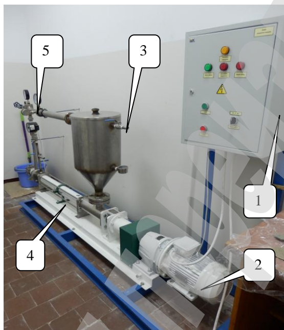
Рис. 2. Гидродинамический кавитатор: 1 – панель управления; 2 – мотор-редуктор; 3 – реактор; 4 – винтовой насос; 5 – гомогенизатор
