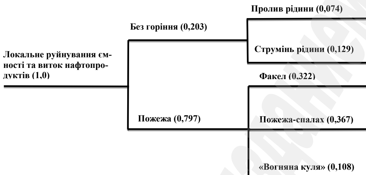
Рис. 1. Схема «Дерева подій» локального руйнування ємності з нафтопродуктами на автозаправній станції
