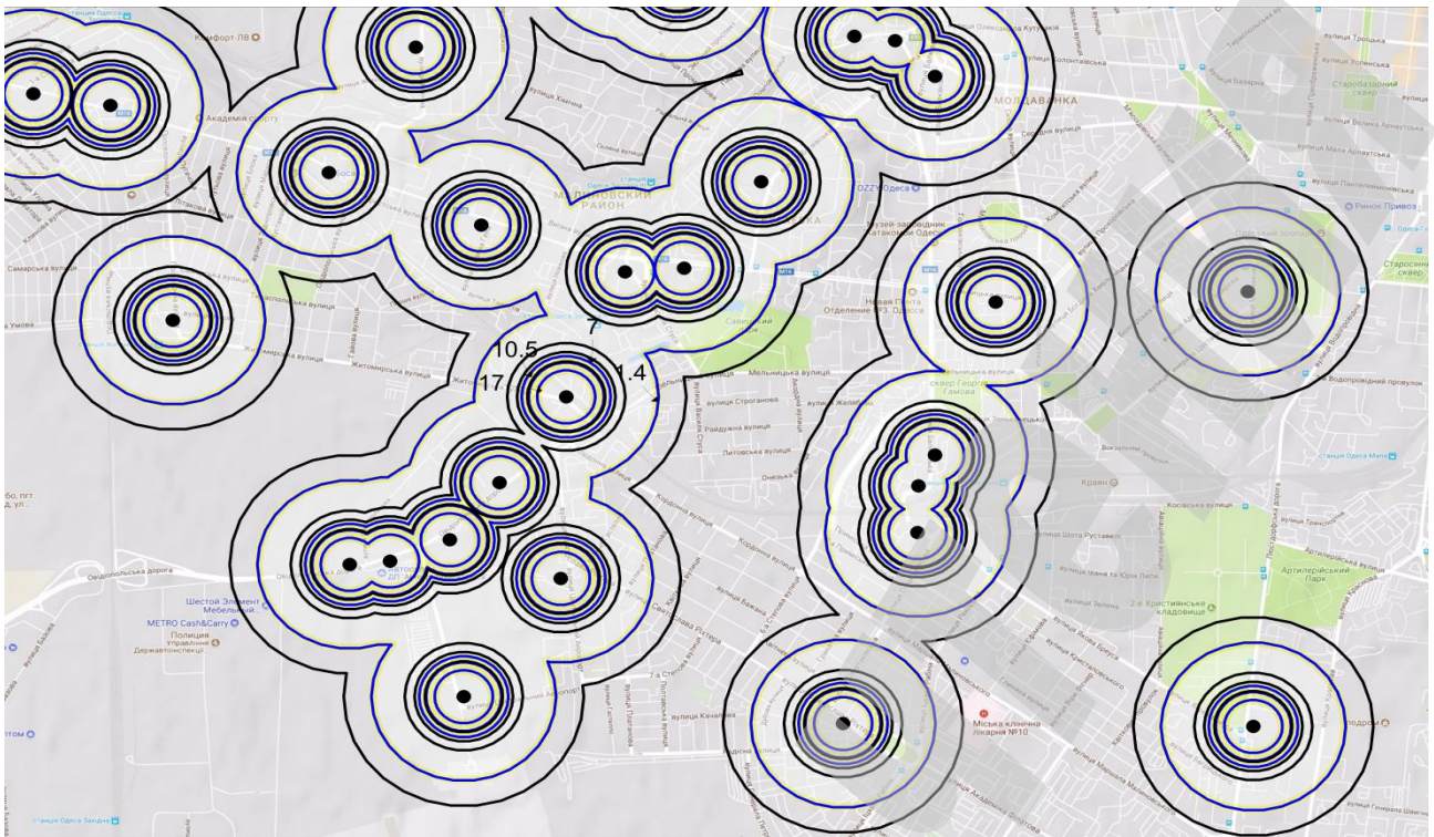
Рис. 3. Зони ураження тепловим випромінюванням від пожежі проливу на АЗС, розташованих в межах території Малиновського району: жовтий колір – радіус зон дії для проливу бензину А-95; чорний колір – радіус зон дії для проливу бензину А-92; синій колір – радіус зон дії для проливу дизельного палива (масштаб 1:36780)
